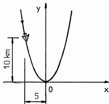
1. Kuvan hävittäjälentokone tekee syöksyn likimain kuvan paraabeliradan mukaisesti. Lentäjään kohdistuvan keskeiskihiityvyyden maksimiarvon on oltava pienempi kuin  $5 g$ . ( $g = 9,81 \text{ m/s}^2$ ). Mikä on koneen suurin salittu nopeus kohdassa O?
