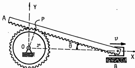
2. Suoran hammastangon toinen pää B liikkuu vaakasuoralla alustalla vakionopeudella  $v$  oikealle. Määritä tangon kulmanopeus ja kulmakihiityvyys kulman  $\bar{\theta}$  funktiona. Käytä *sidotun (kytketyn) liikkeen* menetelmää.
