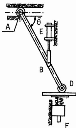
4. Männän F liikettä säädetään hydraulisella sylinterillä E. Määritä sauvan AD kulmanopeus ja pisteen A nopeus hetkellä, jolloin kulma  $\bar{\theta} = 30^\circ$  ja männän F nopeus  $2 \text{ m/s}$  alas päin. Muodosta vektoriyhtälö ja ratkaise se.
