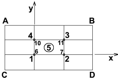
$$\begin{bmatrix} \text{Node} & \underline{x} & \underline{y} & \underline{u} & \underline{v} \\ 6 & 0 & 0 & 0 & 0 \\ 7 & 1000 & 0 & 0,3 & 0,1 \\ 10 & 0 & 500 & 0 & 0 \\ 11 & 1000 & 500 & -0,4 & 0,4 \end{bmatrix} \begin{matrix} 1 \\ 2 \\ 3 \\ 4 \end{matrix}$$
