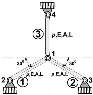
4. Ratkaise elementtimenetelmällä kuvan ristikorakenteen alimmat ominaisstaajuudet käyttäen keskitettyä massamatriisia. Sauvojen poikkipinta-ala on  $A$ . Sauvojen pituus  $L=3 \text{ m}$ . Materiaalina olevan teräksen tiheys on  $\rho$ .
