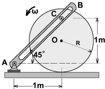
3. Kuvan systeemin ympyrälevy liikkuu luistamatta vastapäivään vakiokulmanopeudella  $\omega=5 \text{ 1/s}$ . Ympyrälevyn tappi **C** liikkuu hahlossa. Määritä vektorialgebran keinoin hahlosauvan **AB** kulmanopeus ja kulmakihiityvyys hetkellä, kun hahlosauvan ja vaakataslon välinen kulma on  $45^\circ$ .
