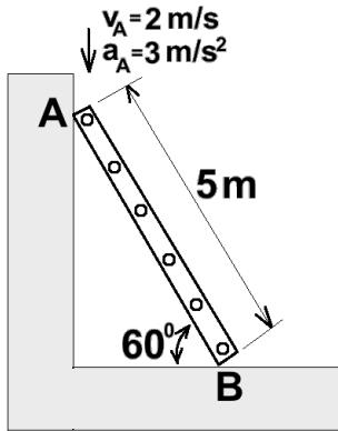
2. Kuvassa tikkaat ovat liistamassa seinustaa ja lattiaa pitkin. Tikkaiden yläpään **A** nopeus on **2 m/s** ja kiihtyvyys **3 m/s<sup>2</sup>** alaspäin kuvassa näkyvällä kulman arvolla **60°**. Määritä vektorialgebran keinoin tikkaiden **AB** kulmanopeus ja tikkaiden alapään pisteen **B** nopeus ja kiihtyvyys kuvan hetkellä. Tikkaiden pituus on **5 m**.
