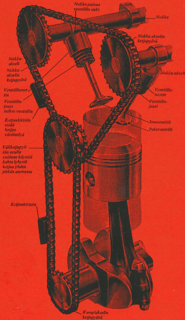
VENTTILIKONEISTO YLÄPUOLISIN NOKKA-AKSELEIN
