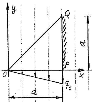
3. Oheisen kolmiolevyn OPQ sivun OP normaalijännityksen lauseke on  $q_0 \frac{x}{a}$ . Sivu OQ on kuormittamaton. Käytä jännitysfunktiota  $\phi = Ax^3 + Bx^2y + Cxy^2 + Cy^3$ . Määritä vakiot A, B, C ja D sekä sivun PQ jännitysten lausekkeet.
