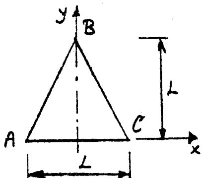
2. Teräslevyssä on homogeninen tasojännitystilakenttä, jonka komponentit ovat  $\sigma_x = 180 \text{ MPa}$ ,  $\sigma_y = -100 \text{ MPa}$  ja  $\tau_{xy} = 80,8 \text{ MPa}$ . Määritä levyn muodonmuutostilakenttä sekä kulman ABC muutos.  $E = 210 \text{ GPa}$ ,  $\nu = 0,3$ .
