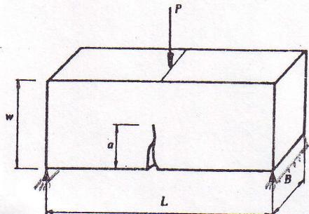
1. Eräästä metalliseoksesta tehty kuvaan mukainen koekappale murtui kuormittavan voiman arvolla 53,2 kN. Laske materiaalin murtumissitkeys.  $L = 200 \text{ mm}$ ,  $w = 100 \text{ mm}$ ,  $B = 50 \text{ mm}$ ,  $a = 53 \text{ mm}$ .
